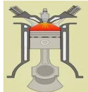
**Gambar 4.** Proses pembakaran pada mesin diesel
