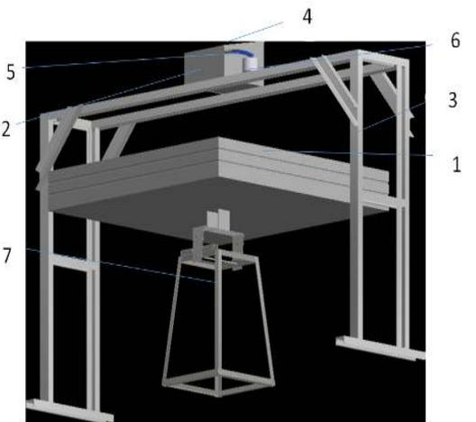
Gambar 2. Desain destilator menggunakan reflektor plat rata
