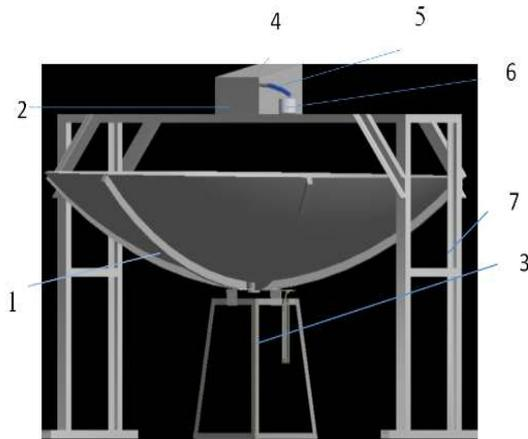
Gambar 1. Desain destilator menggunakan reflektor cekung
