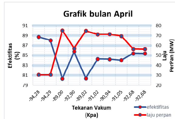
Gambar 3. Grafik Hubungan Efektivitas Dan Laju Perpindahan Panas Terhadap Tekanan Vakum Kondensor Pada Bulan April
