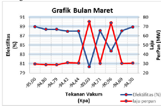
Gambar 2. Grafik Hubungan Efektivitas Dan Laju Perpindahan Panas Terhadap Tekanan Vakum Kondensor Pada Bulan Maret
