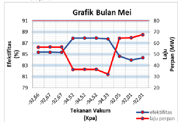
Gambar 4. Grafik Hubungan Efektivitas Dan Laju Perpindahan Panas Terhadap Tekanan Vakum Kondensor Pada Bulan Mei.
