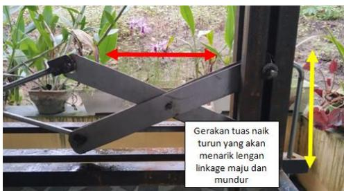
Gambar 6. Mekanisme tuas pelampung
