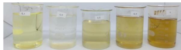
**Gambar 3.** Pengolahan air limbah kelapa sawit dengan metode Fenton setelah proses filtrasi
