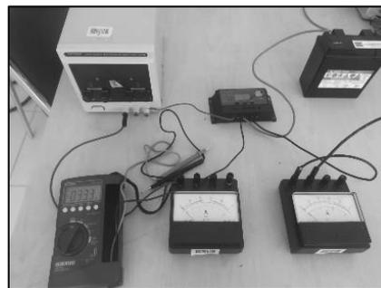
**Gambar 5.** Penyusunan komponen pengujian efisiensi SCC PWM.
