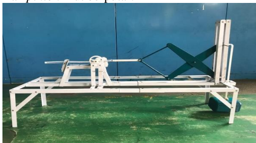
Gambar 10 Hasil Perakitan Model prototype PLTGL tipe linkage
