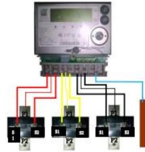
**Gambar 16.** Pengawatan sistem 3 Phasa Tidak Langsung
