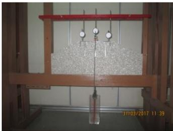
**Gambar 9.** Alat dan kotak pembebanan yang terpasang pada model tanah timbunan.
