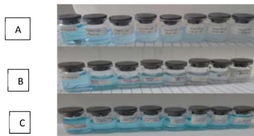
**Gambar 4.** Perubahan warna larutan MB setelah waktu irradiasi 3 jam menggunakan katalis (A)  $\text{Na}_2\text{Ti}_6\text{O}_{13}$ , (B)  $\text{Na}_2\text{Ti}_6\text{O}_{13}:\text{Cu}$ , (C)  $\text{Na}_2\text{Ti}_6\text{O}_{13}:\text{Ag}$ .
