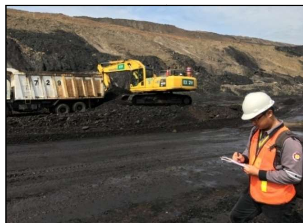
Gambar 2. Alat Backhoe Melakukan Loading Batubara
