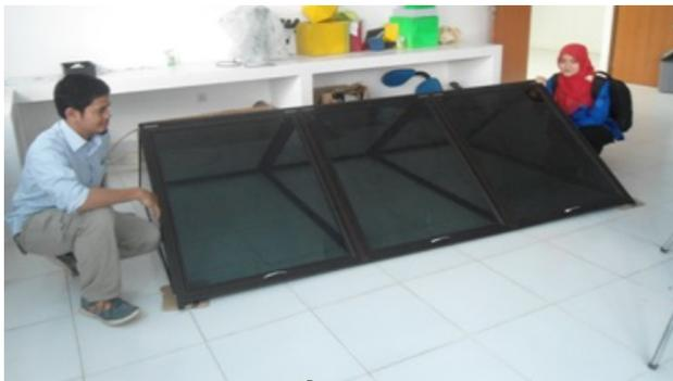
**Gambar 5.** Penutup bak pada destiator.
