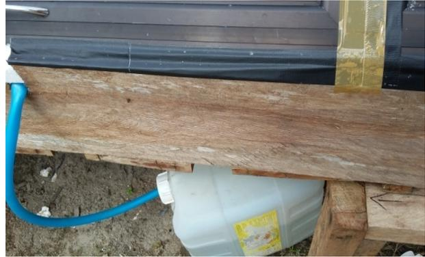
**Gambar 7.** Proses pengaliran air hasil penguapan ke wadah
