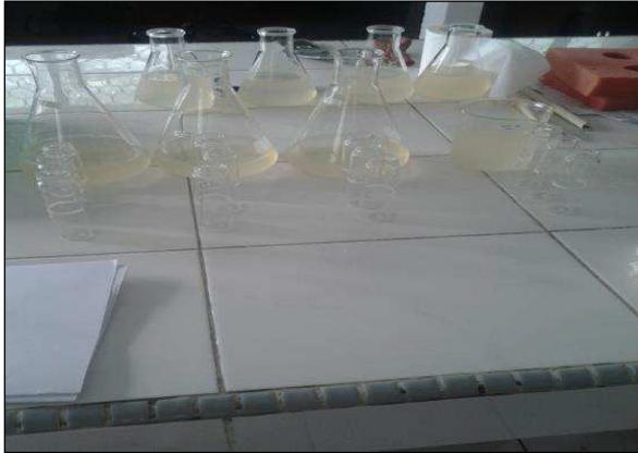
Gambar 2. Uji Sampel NaOH dan Ca(OH)<sub>2</sub> dalam Waktu Pengendapan 60 Menit.
